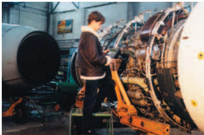
Измерение уровня вибрации межвального подшипника прибором "Кварц" на авиационно-технической базе Внуково
