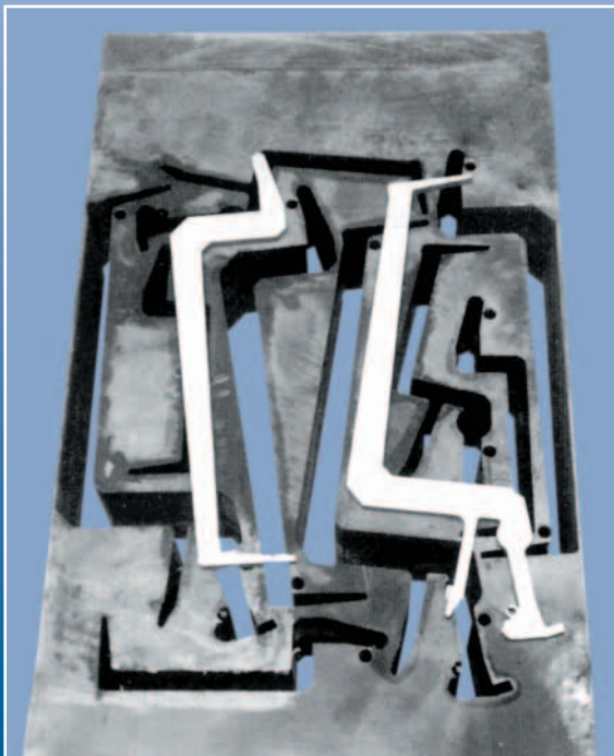
Контактные рычаги, изготовленные методом электроэрозионной резки
