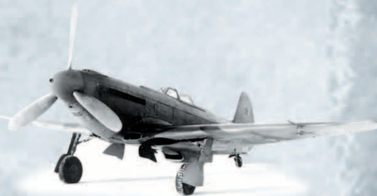
Истребитель Як-9У с мотором ВК-107А
