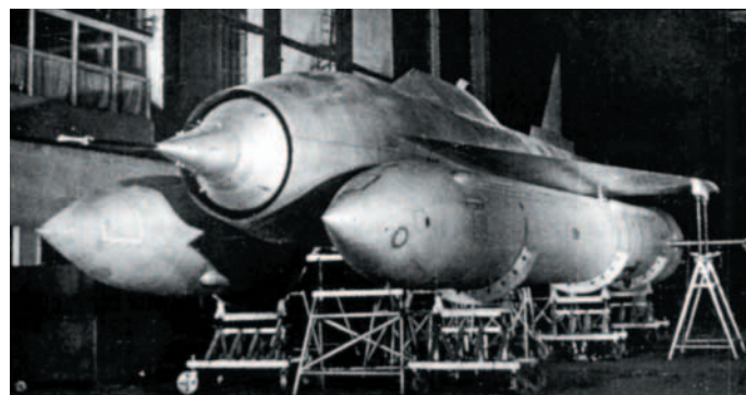
Крылатая ракета "Буря" в сборочном цехе
