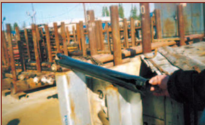
Разрыв диафрагмы погружного электронасоса
