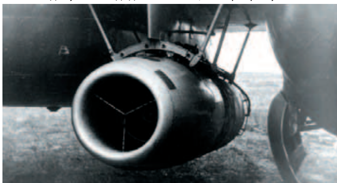
Дозвуковой ПВРД РД-900 на летающей лаборатории Ту-14
