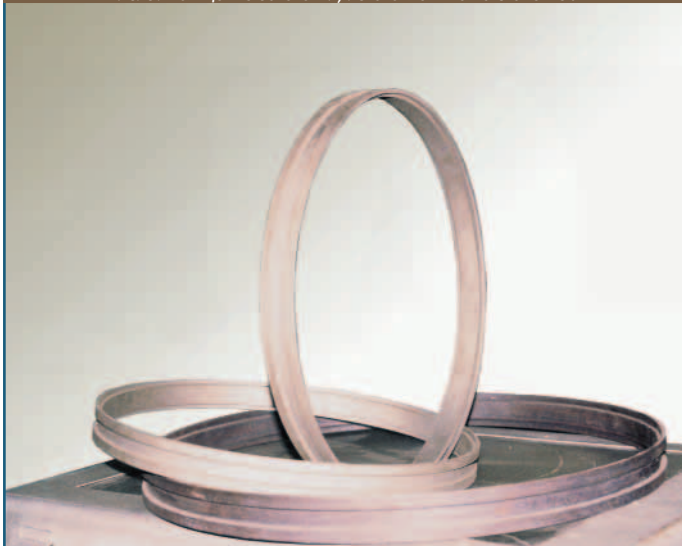
Рис. 3. Кольцевые заготовки, изготовленные на стане 280
