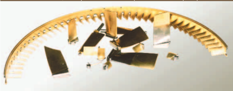
Рис. 5. Защитное эрозионностойкое покрытие лопаток компрессора
