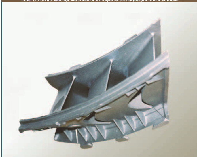
Рис. 1. Литой сектор соплового аппарата из жаропрочного сплава
