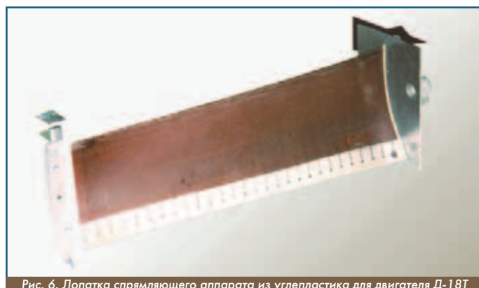
Рис. 6. Лопатка спрямляющего аппарата из углепластика для двигателя Д-18Т
