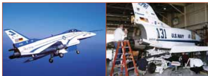
Рисунок 1.64 - Экспериментальный самолёт Rockwell-MBB X-31A: а) - в полёте; б) - монтаж газовых рулей
