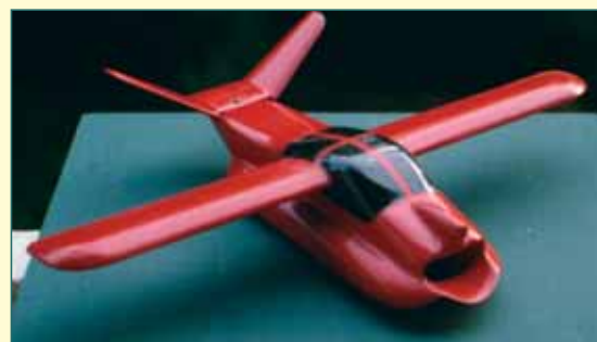
Рис.7. Модель двухместного самолета с ШВП "Фрогги-2"
