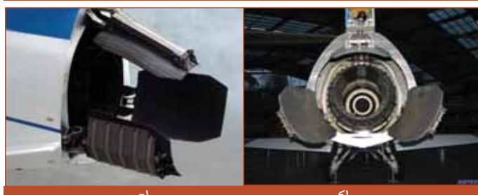
Рисунок 1.65 - Система отклонения вектора тяги двигателя на самолёте X-31A: а) - вид сбоку; б) - вид со стороны сопла ТРДДФ F404-GE-400
