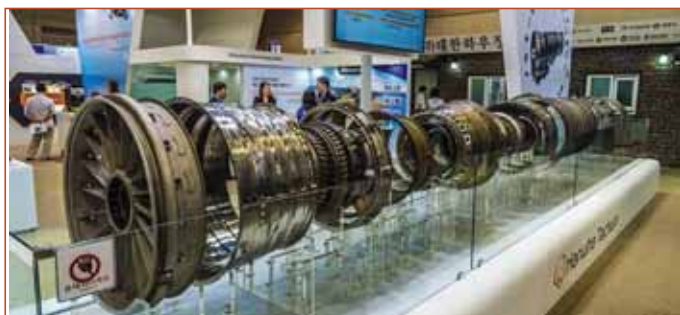
Рисунок 1.77 -Основные модули ТРДДФ F404-GE-102
