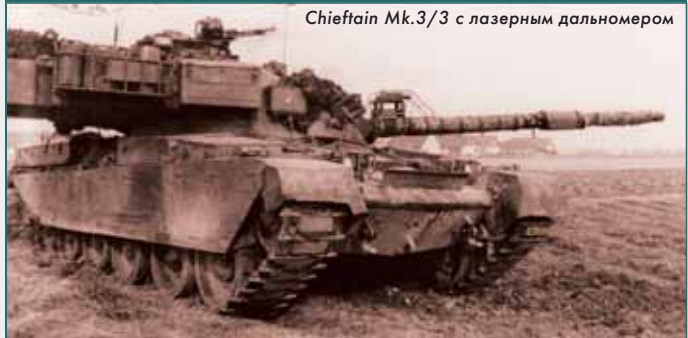
Chieftain Mk.3/3 с лазерным дальномером
