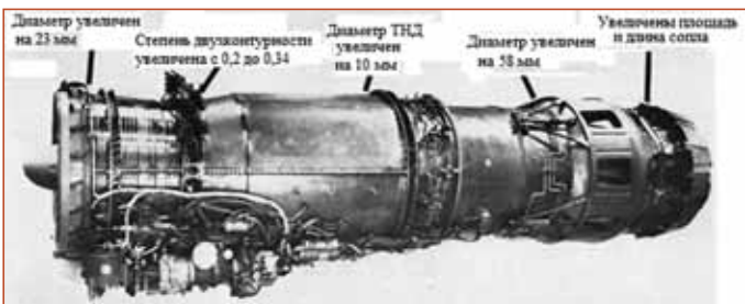
Рисунок 1.53 - Изменения в конструкции ТРДДФ F404-GE-400 по сравнению с YJ101
