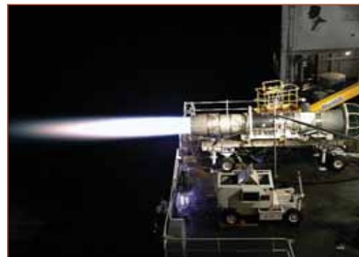
Рисунок 1.60 - Испытание F404-GE-400 на борту авианосца
