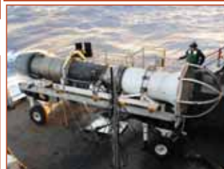
Рисунок 1.72- Подготовка к испытаниям ТРДДФ F404-GE-402 на палубе авианосца
