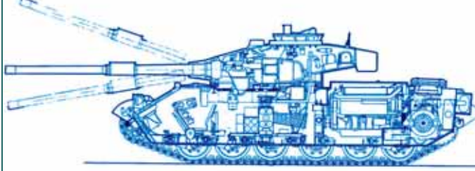
Компоновочная схема танка Vickers Mk.3
