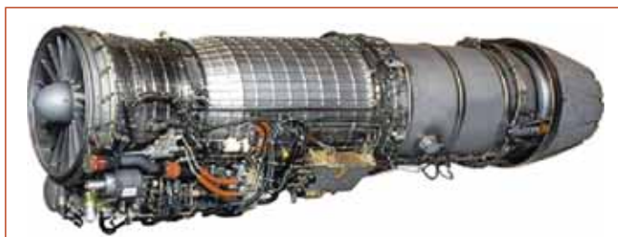
Рисунок 1.46 - Конструктивная схема ТРДДФ F404-GE-400
