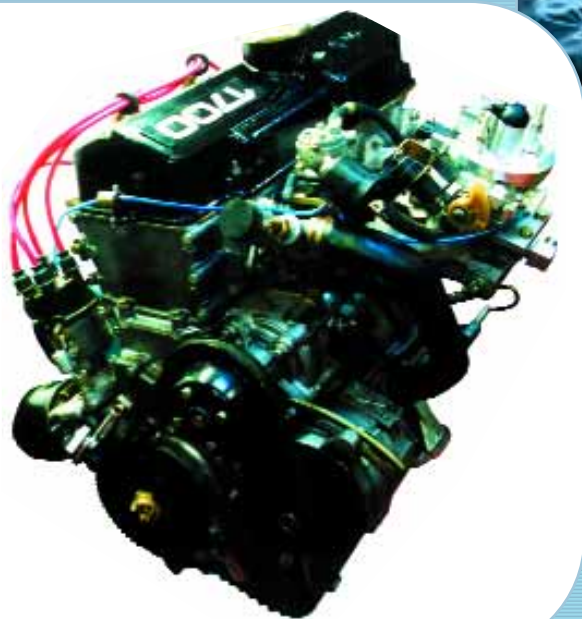
Двигатель V = 1,7 л с центральным впрыском топлива
