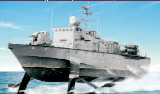
Корабль на подводных крыльях "Сокол" с газотурбинной установкой мощностью 5000 л.с.
