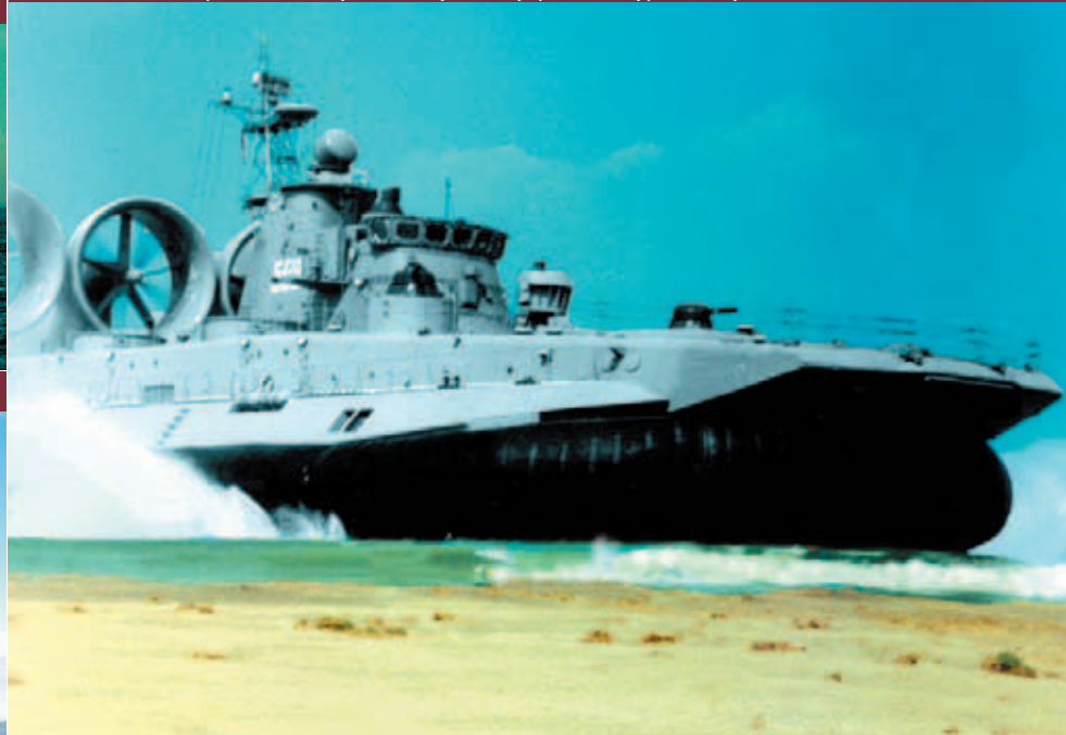
Десантный корабль на воздушной подушке "Зубр" с газотурбинной установкой мощностью 50 000 л.с.
