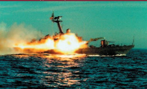
Корабль на подводных крыльях "Сокол" с газотурбинной установкой мощностью 5000 л.с.
