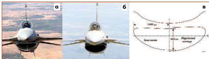
Рис. 1.101 Воздухозаборники F-16C/D: а) "малый рот"; б) "большой рот"; в) размеры зоны входа и зоны наружного контура
