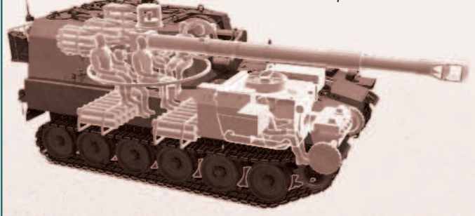
Размещение экипажа, силовой установки, вооружения, автомата заряжания и боеприпасов в САУ Тип 75
