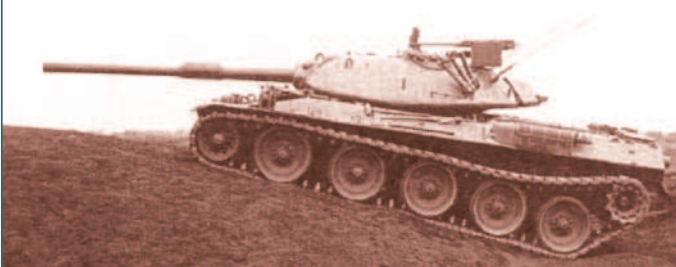
Устранение крена на склоне благодаря гидропневматической подвеске
