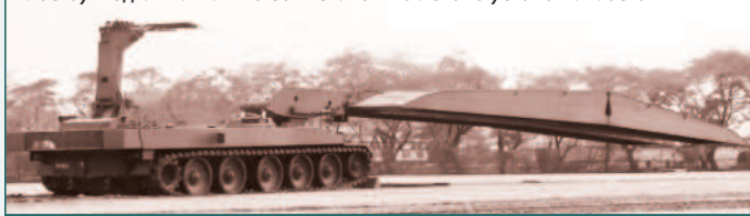
Мостоукладчик Тип 91 на заключительном этапе установки моста
