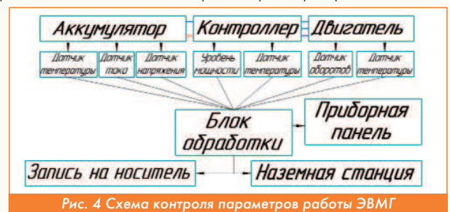
Рис. 4 Схема контроля параметров работы ЭВМГ
