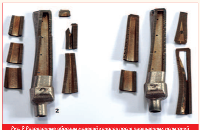
Рис. 9 Разрезанные образцы моделей каналов после проведенных испытаний
