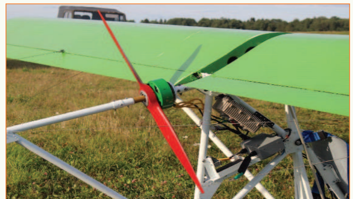
Рис. 3 Воздушный винт, разработанный и изготовленный группой исследователей, компоновка ЭВМГ на самолёте
