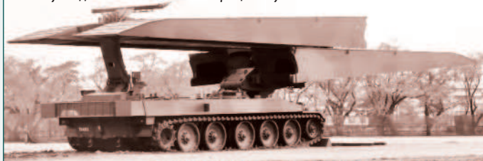
Мостоукладчик Тип 91 на заключительном этапе установки моста
