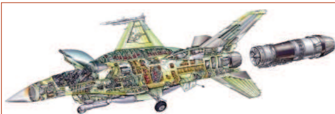
Рис. 1.142 Схема размещения двигателя F110-GE-132 на самолёте F16E/F Block 60
