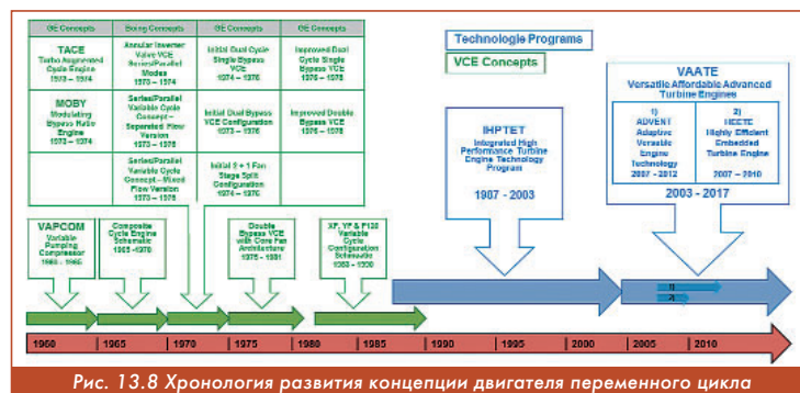
Рис. 13.8 Хронология развития концепции двигателя переменного цикла
