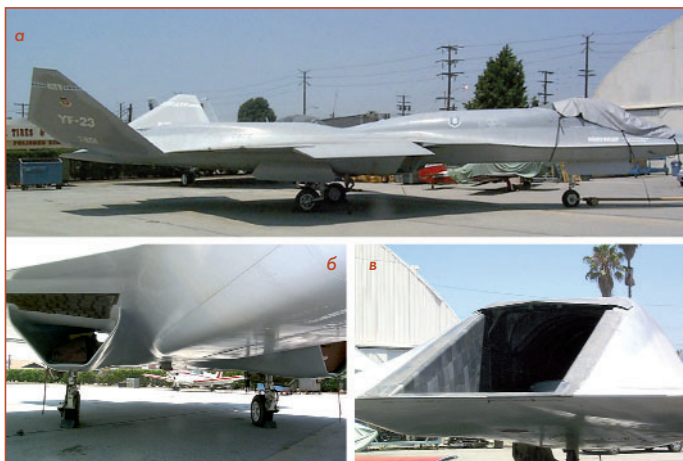
Рис. 13.6 YF-23 Gray Ghost в музее Western Museum of Flight: а - внешний вид; б - воздухозаборник; в - сопло
