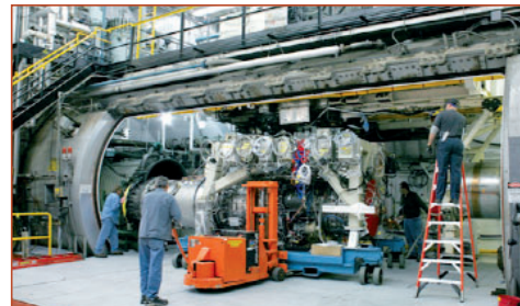
Рис. 17.12 Испытания F136 на стенде в Эвендейле
