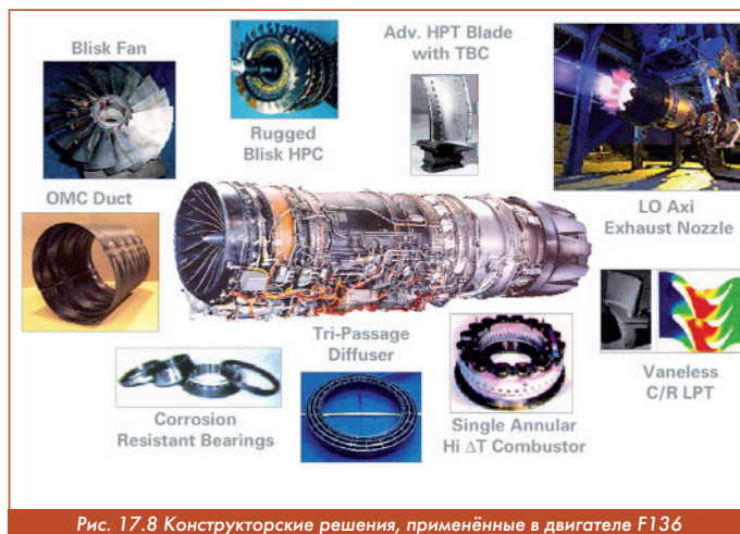
Рис. 17.8 Конструкторские решения, применённые в двигателе F136
