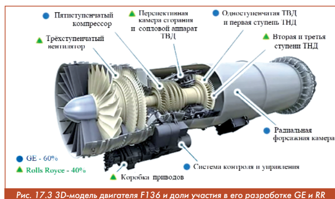
Рис. 17.3 3D-модель двигателя F136 и доли участия в его разработке GE и RR
