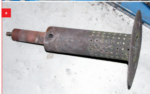
Экспериментальная установка после проведения серии экспериментов: а - верхняя часть установки, б - общий вид без крышки, в - металлический анод
