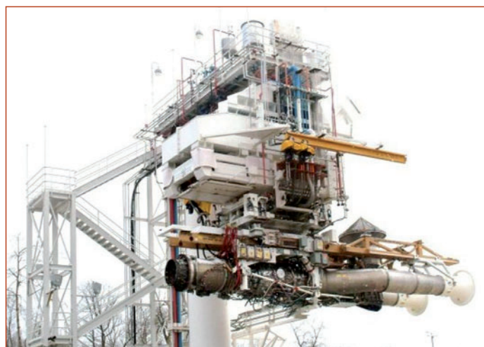
Рис. 17.13 Испытания F136 STOVL на открытом стенде в Пиблсе
